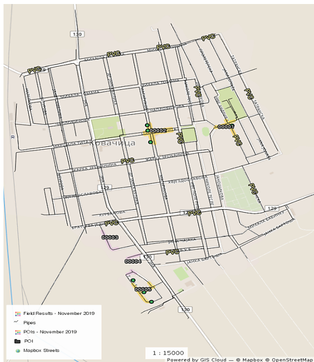
Slika 7. Vodovodna mreža naselja Kovačica sa mestima otkrivenog ( i potencijalnog) curenja
