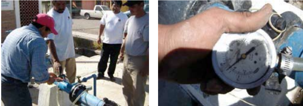
FIGURA 9: MATJET E PRESIONIT ME MATËS TË TIPIT "BOURDON"
